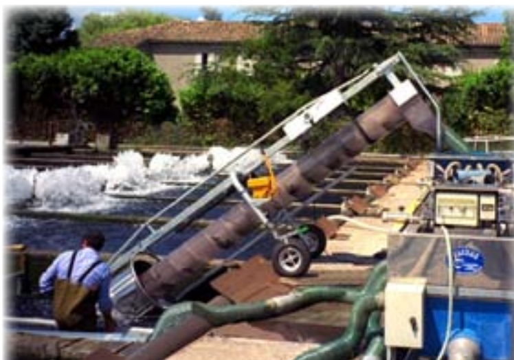
Serie 77 TORNILLO Ø 330 mm - 4,5 m de longitud.
