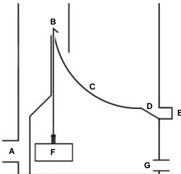
Während das Wasser das Filterelement durchströmt werden die Wassertropfen aufgespaltet und mit Sauerstoff angereichert
